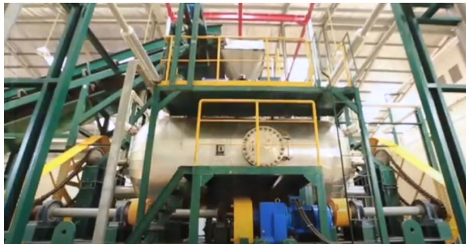
Thiết bị hấp ướt áp suất cao thể tích 10 m3
